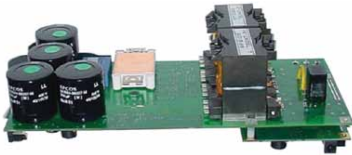
Рис. 9. Демонстрационный макет AC/DC-преобразователя с ККМ (конденсатор CeraLink – синего цвета, четыре алюминиевых конденсатора – черного цвета)
