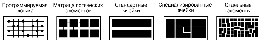
Рис. 1.17. Методы разработки специализированных ИС.
