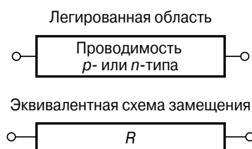
Рис. 1.3. Легированная область и её эквивалентная схема замещения.
