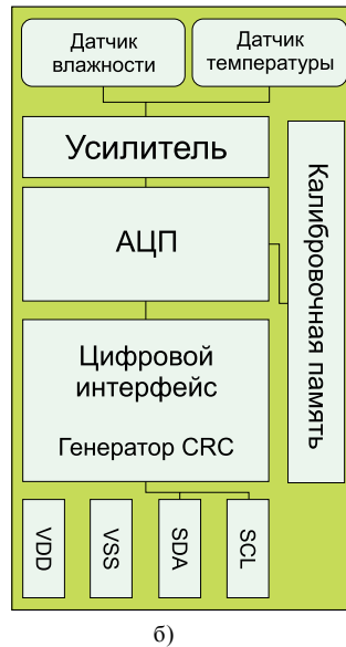
Рис. 5. Емкостная технология Sensirion (а) и внутренняя структура датчика (б)
