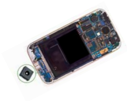
Рис. 3. Плата мобильного телефона Samsung Galaxy S4 с датчиком Sensirion
