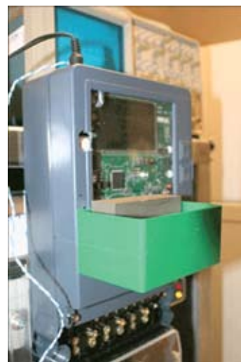
Рис. 13. Испытание счетчика с внешним магнитом РТВ
