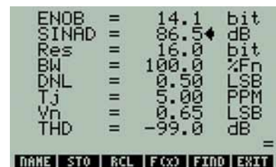
Рис. 11. SINAD для АЦП MAX1162 составляет 86,5 дБ
